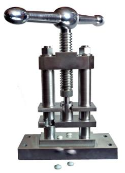
Пресс лабораторный РВЛП-1315 с комплектом пресс-форм (далее – пресс) предназначен для изготовления брикетов диаметром 13 и 15 мм из порошка эталонной бензойной кислоты для целей градуировки калориметров с калориметрической бомбой.
